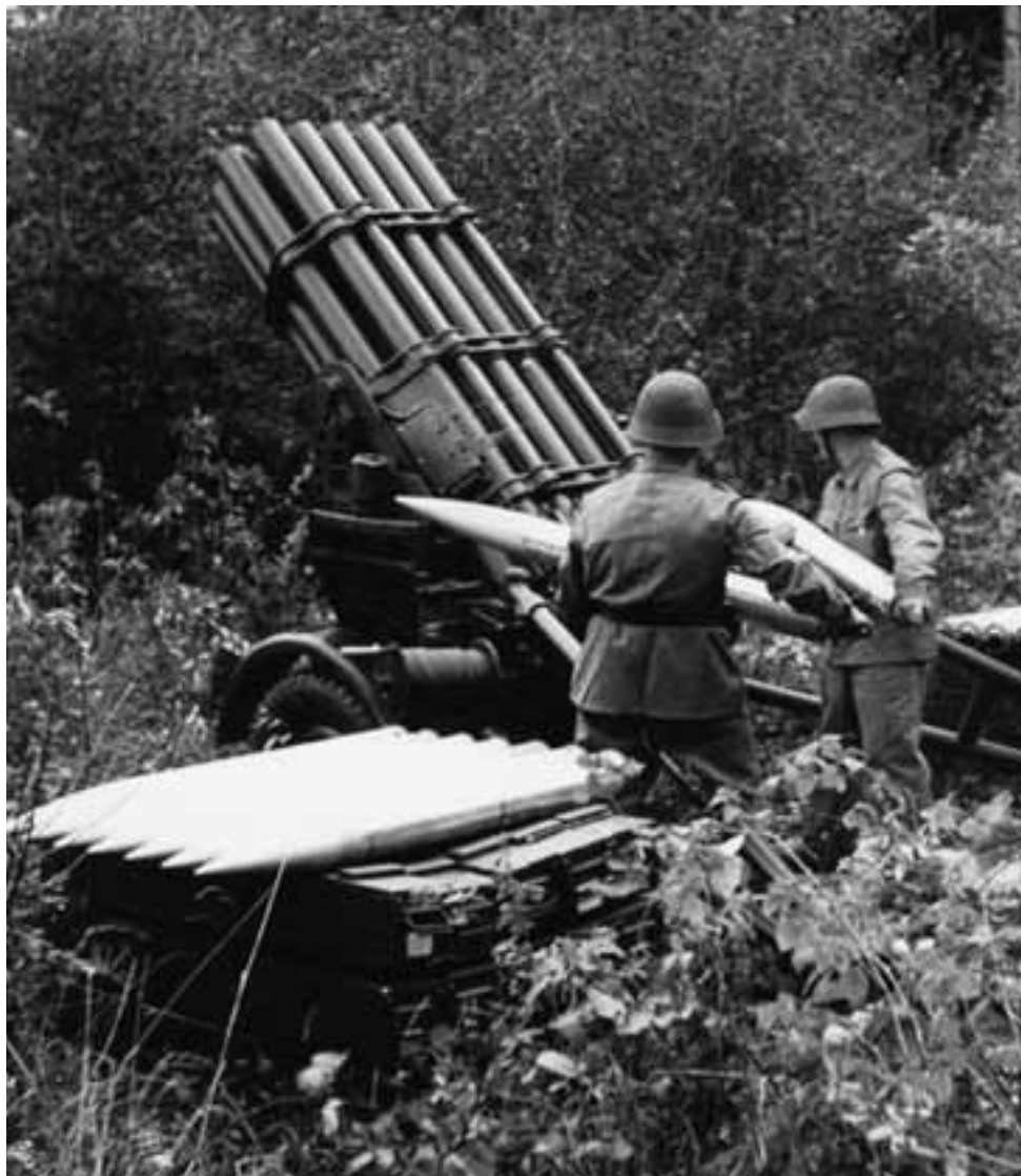
A la fin des années 1940 et au début des années 1950, la division technique (KTA) a procédé à d'importants essais de roquettes d'artillerie développées en Suisse. La photo est celle d'un lanceur de 12 cm testé en 1951. Nous reviendrons plus en détail sur ces essais dans un bulletin à venir.
