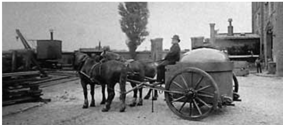
Tourelle cuirassée mobile à canon de 5,3 cm (Fahrpanzer).
