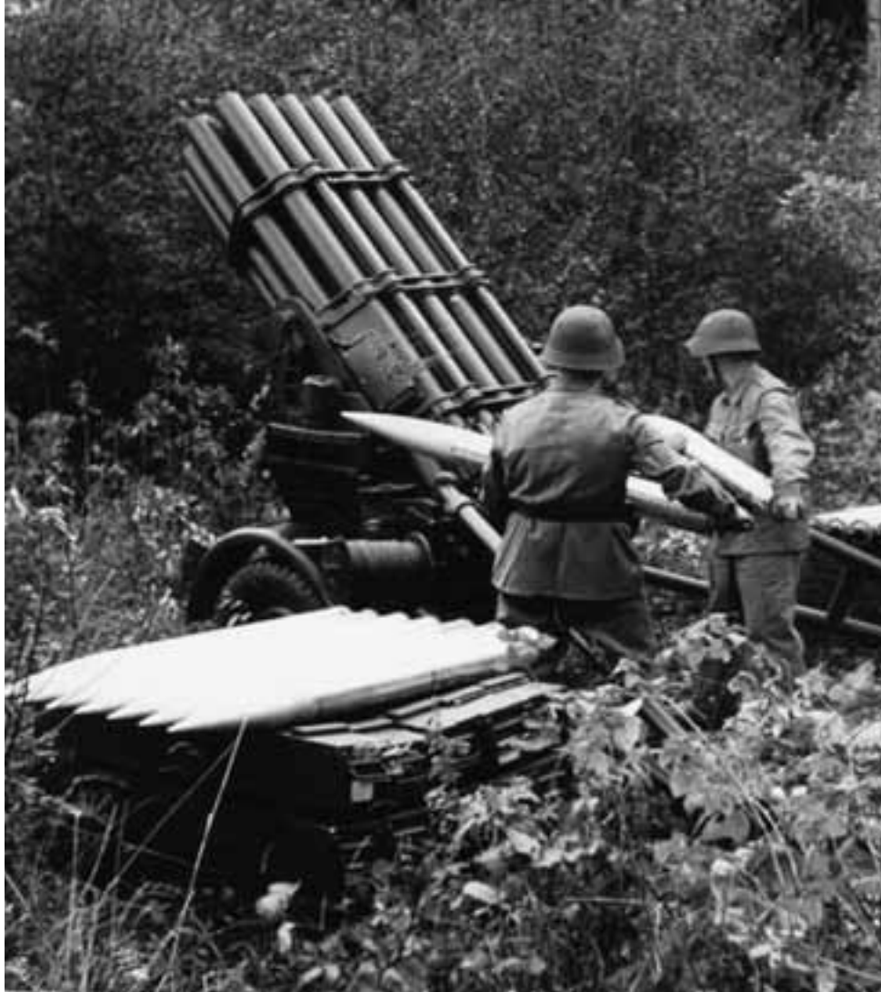
Ende der 1940er- und anfangs der 1950er-Jahre wurden durch die Kriegstechnische Abteilung (KTA) umfangreiche Versuche mit in der Schweiz entwickelten Artillerie-Raketen durchgeführt. Das Bild zeigt einen der 1951 erprobten Werfer im Kaliber 12 cm. In einem der nächsten Bulletins werden wir näher auf diese Erprobungen eingehen.
