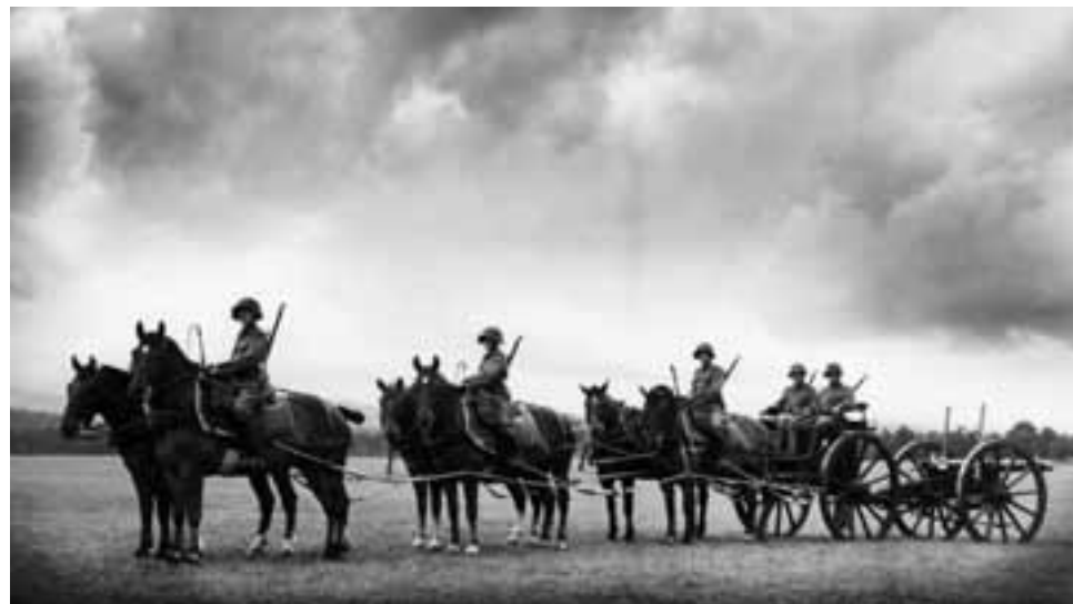
8,4 cm Kanone, angespannt in direktem Zug, alle Zugstrangen führen direkt nach hinten
