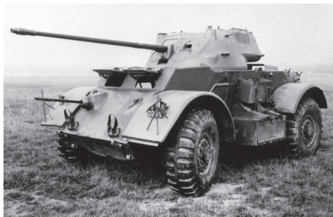
Staghound probablement équipé d'un canon de 34 ou 30 mm par les Ateliers de construction de Thoune.
