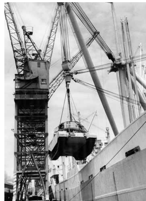
Chargement d'un char à Durban moyennant la grue du navire
