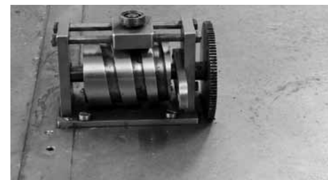
Photo 8: Restes d'anciens lubrifiants et développement de corrosion sur les zones d'interface entre le plateau de la table n° 2 et les éléments mécaniques fixés par vissage
