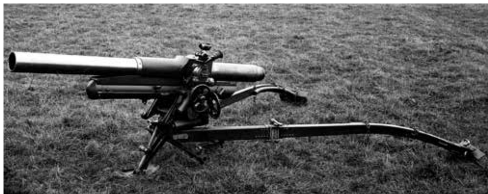
Canon antichar léger de 9 cm 1950 en configuration d'essai 1945/50.
