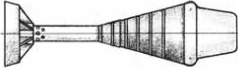
Grenade antichar 44, 2 e version, avec coiffe et fusée améliorées (Pz WG 44). Diamètre d'obus de 95 mm, capacité de perforation de 147 mm.
