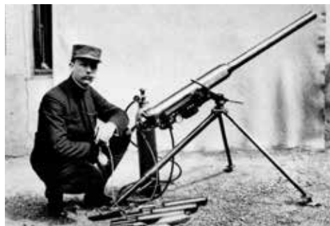
Edgar Brandt à côté de son lance-mines à air comprimé de 60 mm amélioré, modèle 1916. Ce modèle est équipé d'une bonbonne d'air comprimé qui permet d'atteindre une cadence de tir plus élevée. Au premier plan, différents obus.
