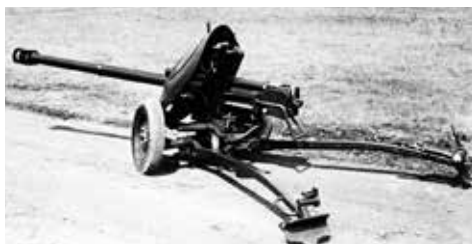
Canon antichar de 9 cm 57 avec frein de bouche, dans sa version d'origine, mais non encore équipé d'un fusil de réglage.
