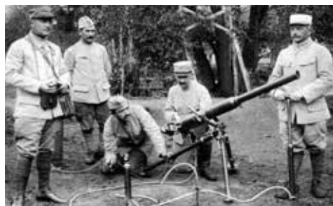
Lance-mines à air comprimé de 60 mm Brandt, modèle 1915, déployé dans le cadre d'une formation. Plusieurs pompes manuelles étaient utilisées pour générer la pression nécessaire.
